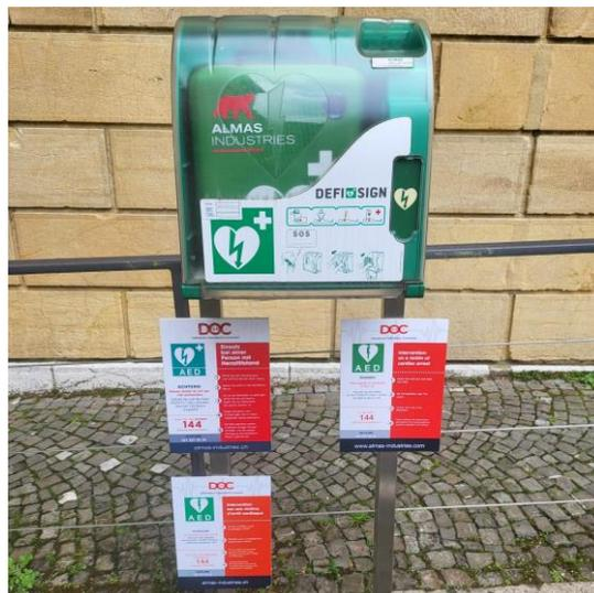
**Ces appareils sont à utiliser en cas d'arrêt cardio-respiratoire uniquement. Après avoir décroché l'appareil de son boîtier, appuyez sur « Push to Call », un/une opérateur/trice du 144 indique les directives à suivre, étape par étape. Les défibrillateurs sont directement reliés à un centre d'appels d'urgences 24/24 et 7j/7. Des panneaux en français, en allemand et en anglais avec les instructions d'utilisation sont placés à côté de chaque appareil.**
